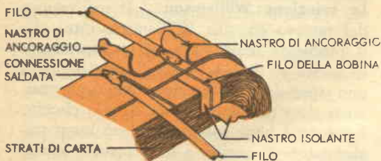
Sistema per effettuare le prese sui secondari in modo da realizzare uguali reattanze di dispersione.
