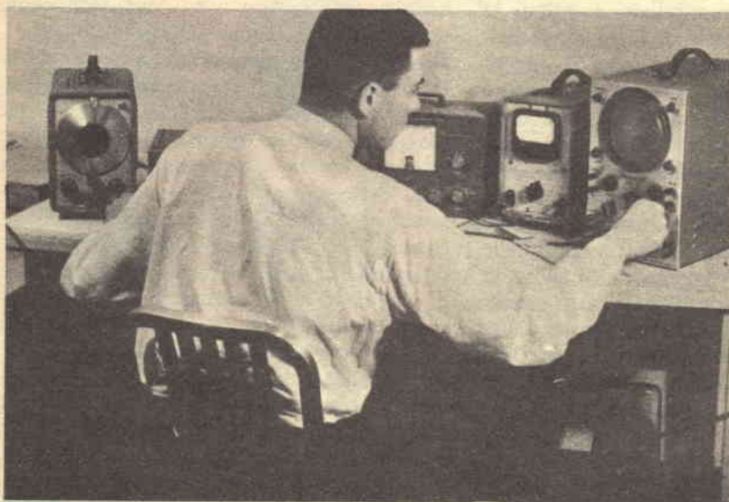
Fig. 2 - Complesso degli strumenti necessari per la misura della distorsione armonica; l'oscilloscopio non è indispensabile, però mostra la reale forma d'onda del segnale dando una indicazione visuale della distorsione.
